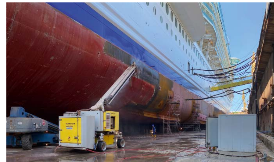
Die Entschichtung von Schiffsrümpfen muss alle fünf Jahre durchgeführt werden. Für das Team von Aquatec bedeutet das eine ganze Reihe von Reisen zu europäischen Trockendocks.
