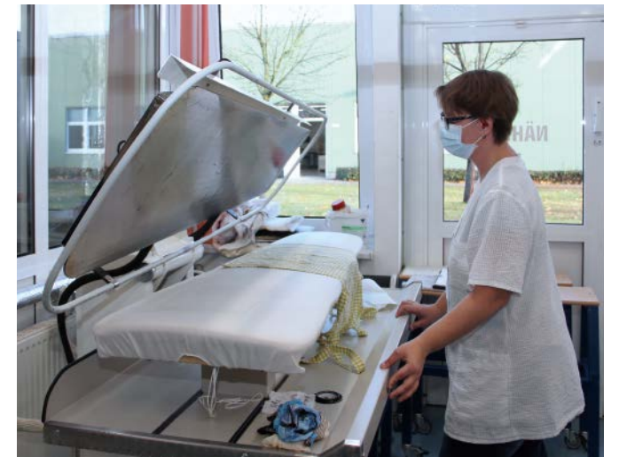
An einer Presse, deren Platte um die 175 Grad heiß ist, werden frisch gewaschene Handtücher, Tischdecken und kleinere Wäschestücke geglättet.
